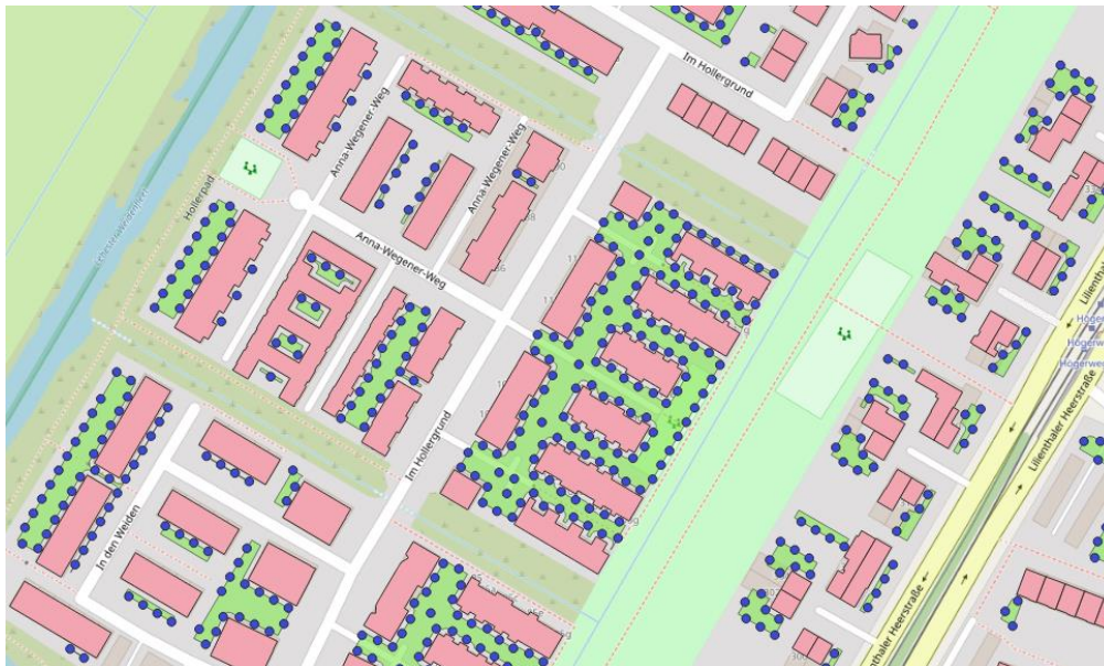
Abbildung 64: Darstellung der Platzierung der EWS auf den Grundstücken für ein Beispielgebiet: Platzierungsbereich auf den Grundstücken (hellgrün); Sondenstandorte (blaue Punkte)
